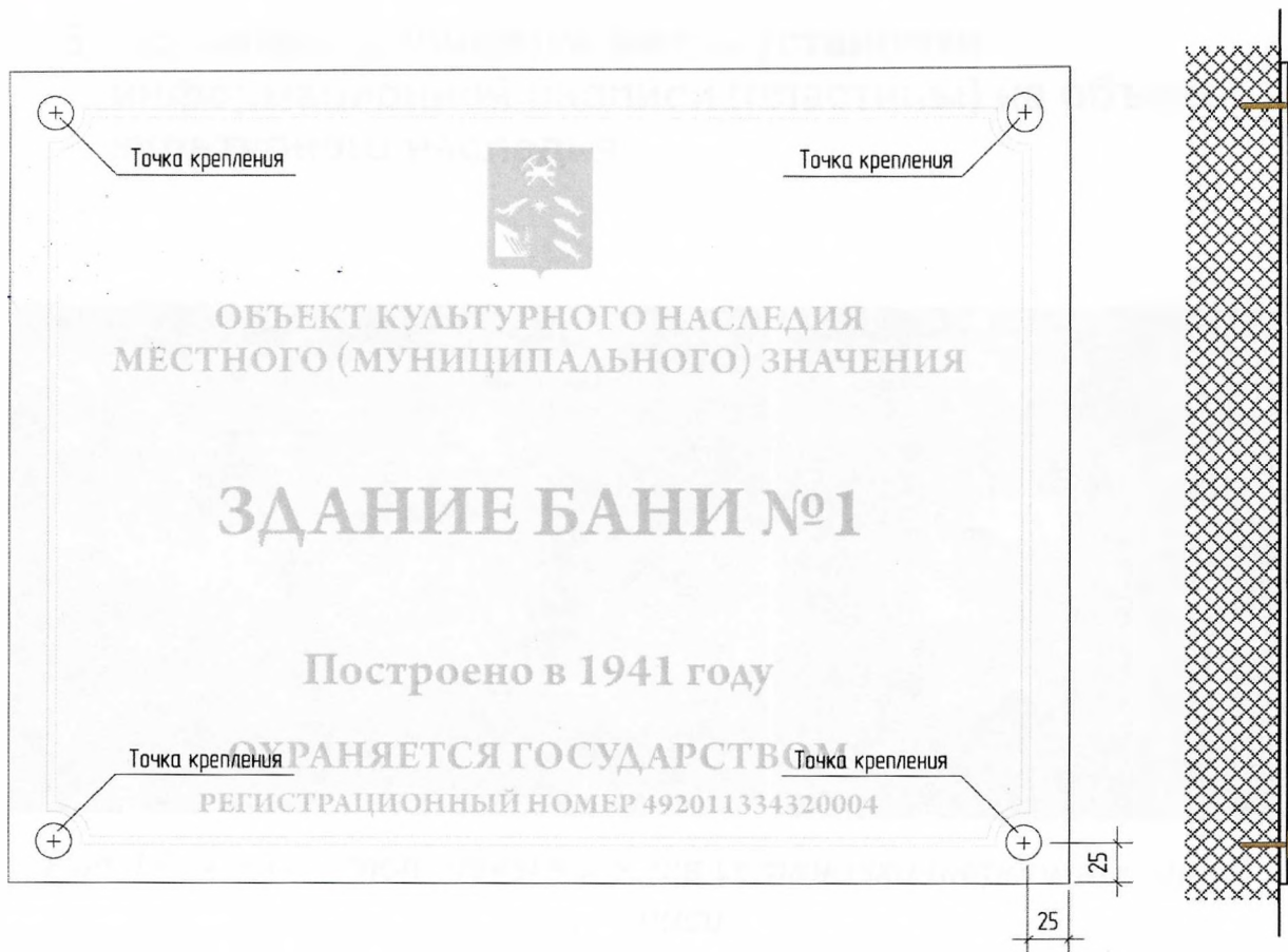
Рис.3 Схема крепления информационной надписи
