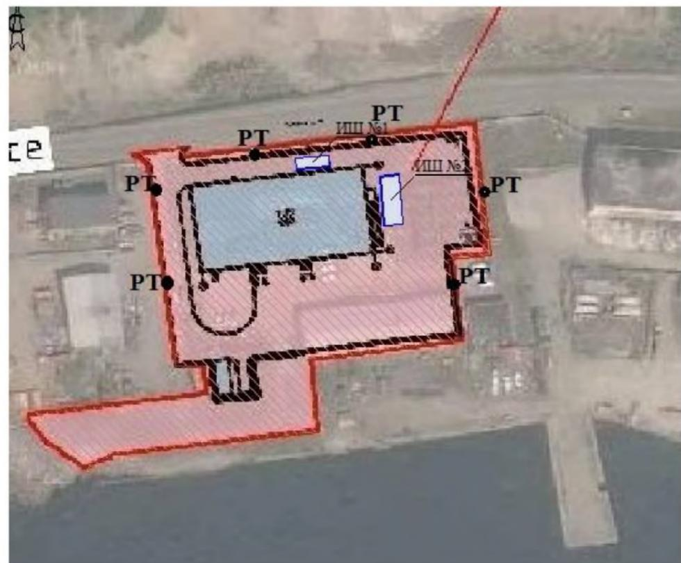
Схема размещения источников шума в период эксплуатации
