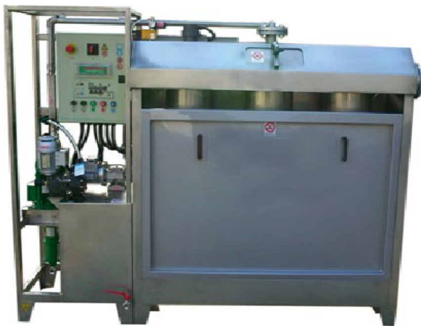
Рисунок 12. Мешковая установка обезвоживания
