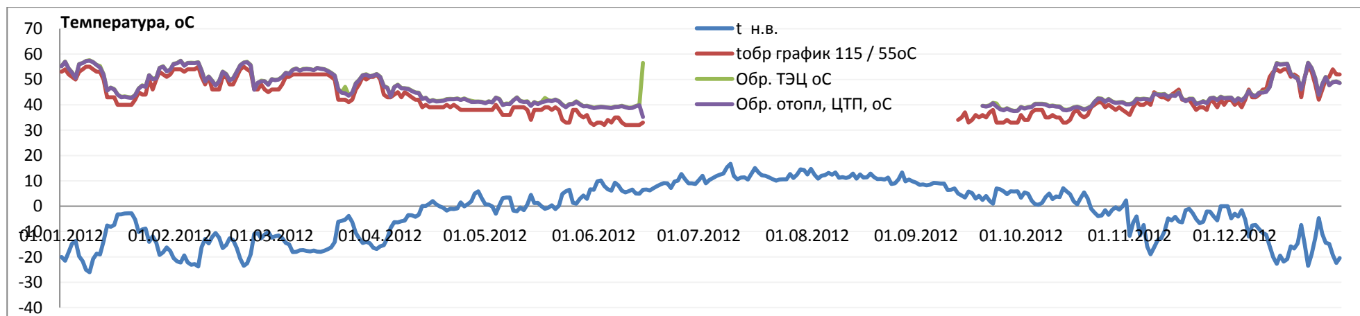
Рисунок 2.9-1 – ЦТП-5: Фактическая температура в обратном теплопроводе от потребителей до МТЭЦ незначительно завышена по отношению утвержденного температурного графика на МТЭЦ.
