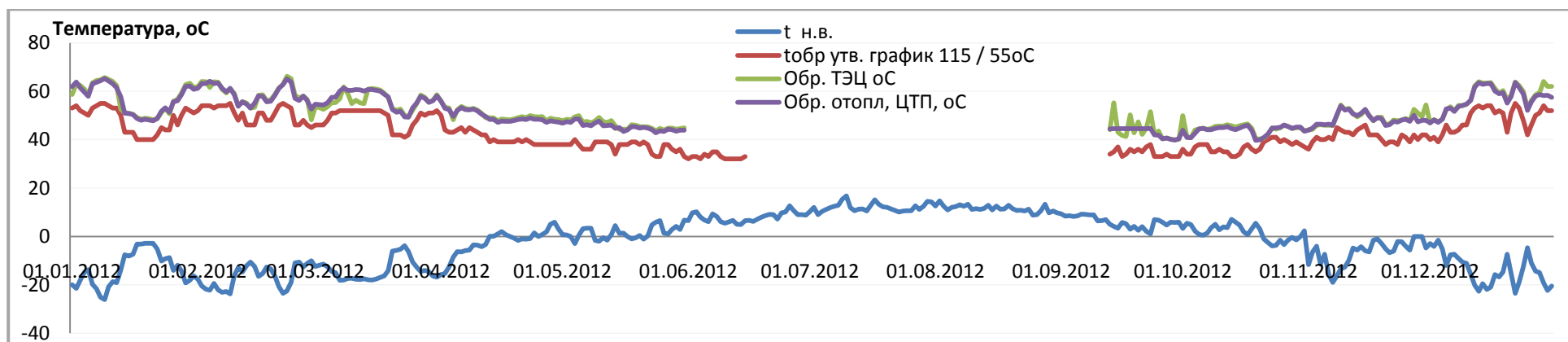
Рисунок 2.11-1 – ЦТП-7: Фактическая температура в обратном теплотрассе от потребителей до МТЭЦ завышена по отношению утвержденному температурному графику на МТЭЦ в среднем на 8 °С.
