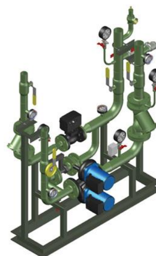
Рисунок 7 Присоединение ГВС по одноступенчатой схеме при зависимой схеме подключения системы отопления (Вариант 1.2.)
