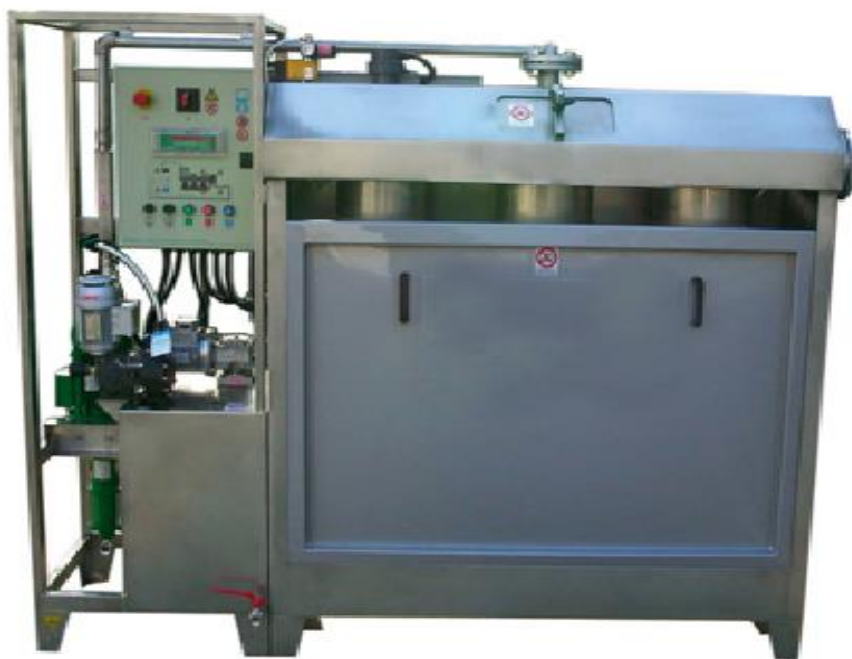
Рисунок 32. Мешковая установка обезвоживания
