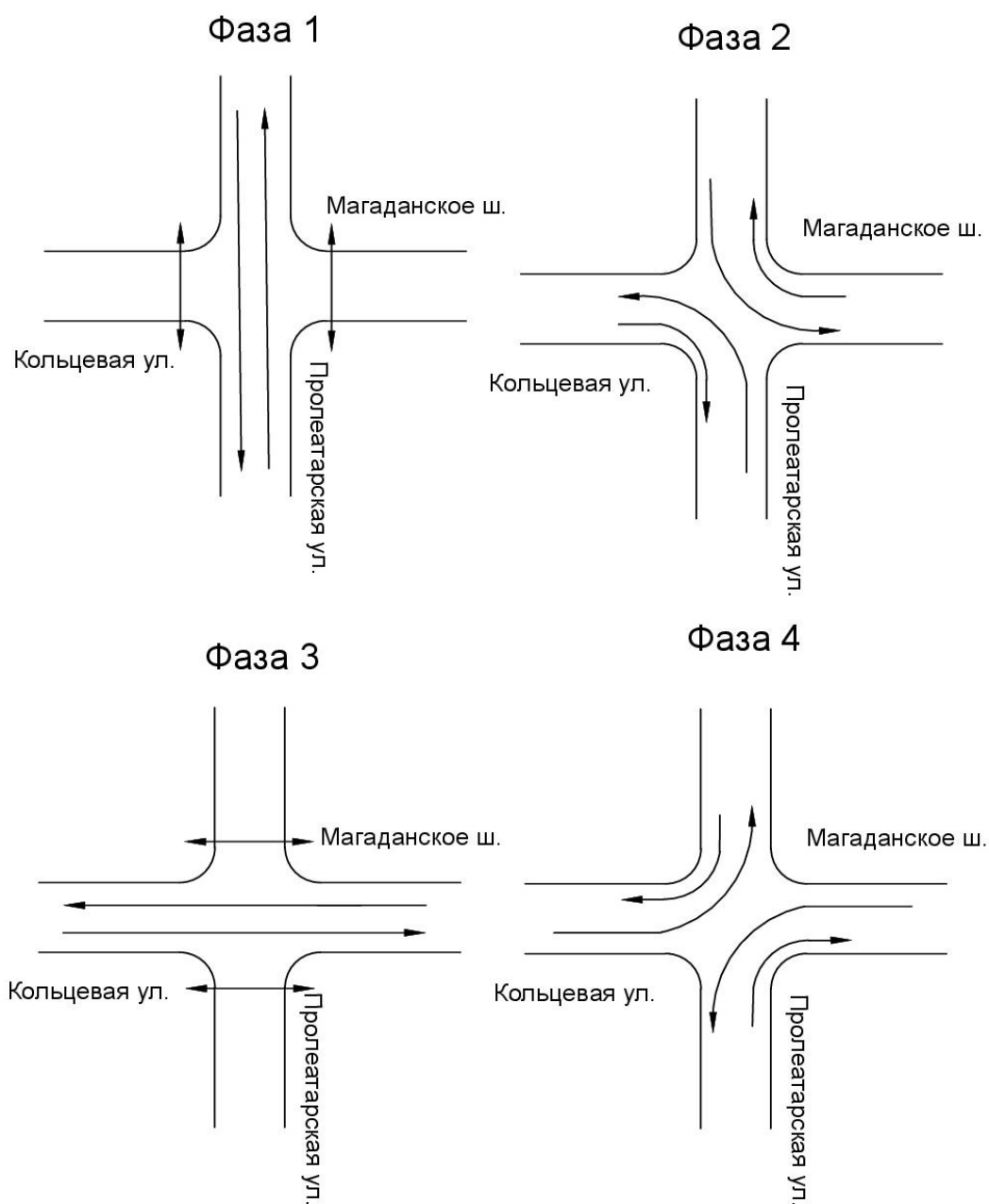
Рисунок 3.3.1 – Предлагаемый пофазный разъезд на пересечении ул. Кольцевая – ул. Пролетарская – Магаданское ш.
