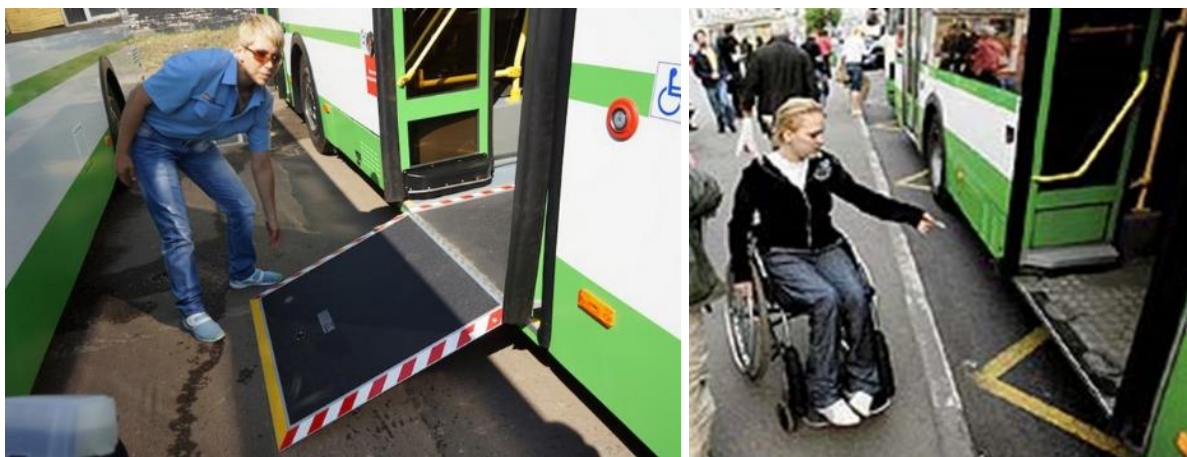
Рисунок 3.16.9 – Зазор между транспортным средством и бортовым камнем о.п.
