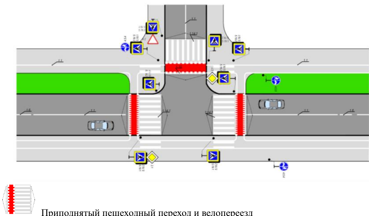
Рисунок 3.5.4 – Типовая схема организации велопереезда, совмещенного с пешеходным переходом
