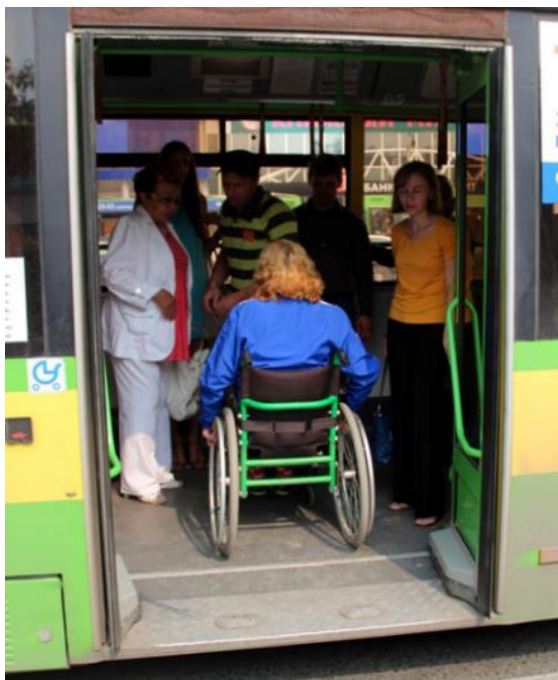
Рисунок 3.16.10 – Отсутствие площадки для представителя МГН в подвижном составе
