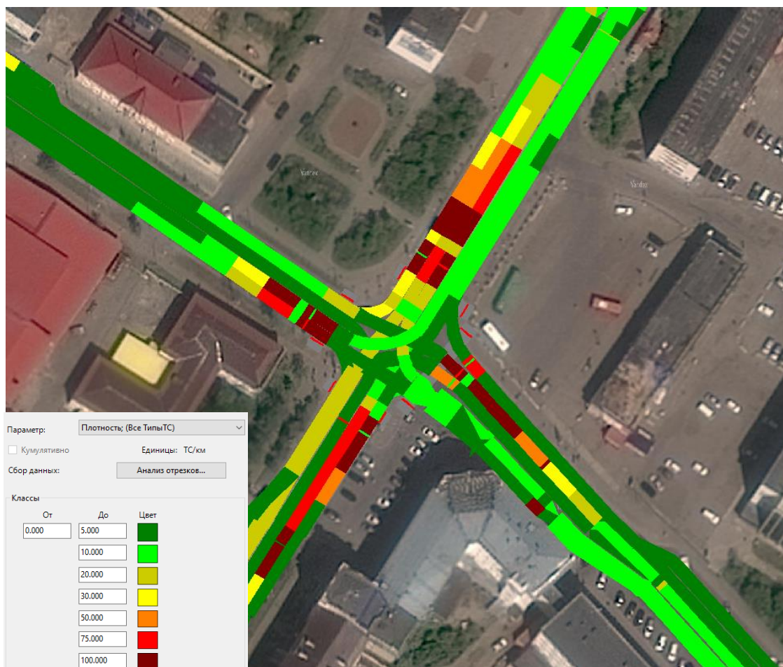
Рисунок 5.18 – Картограмма плотности транспортных потоков на узле
