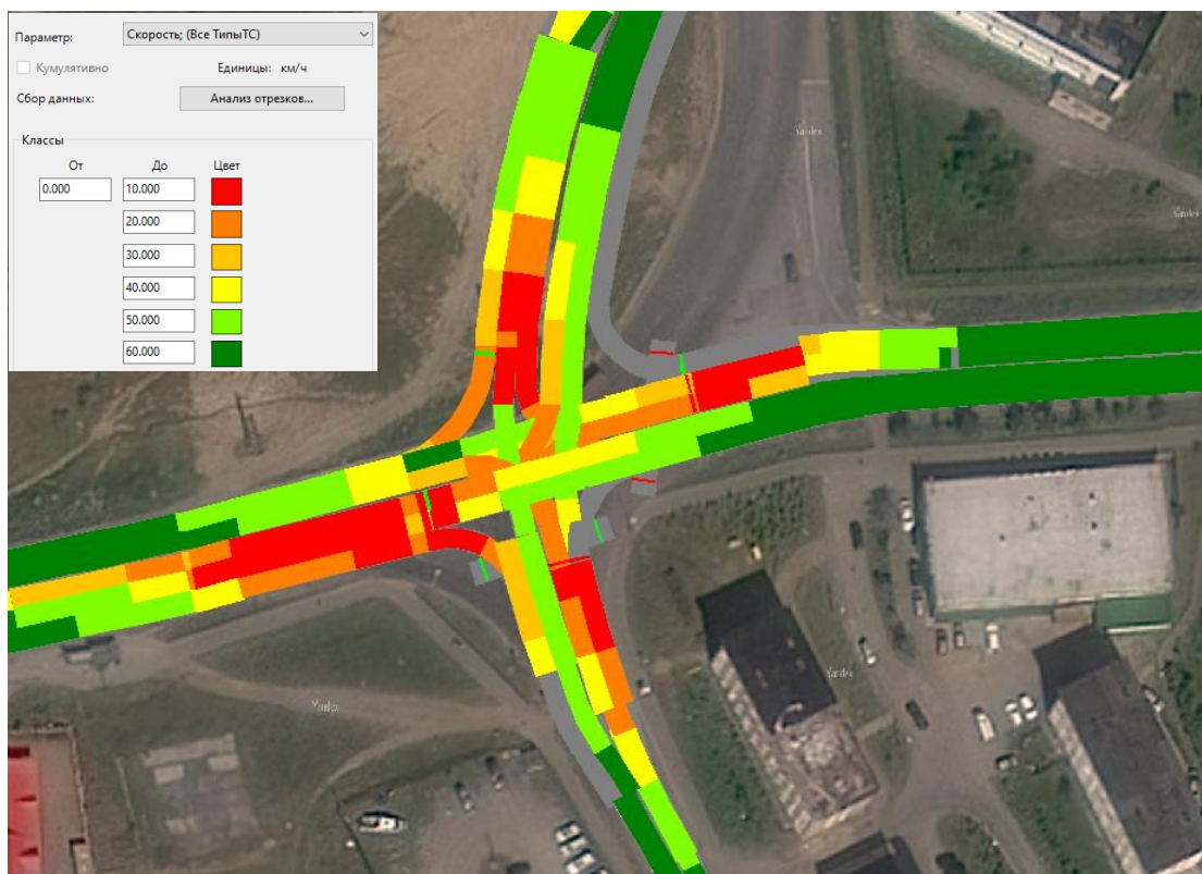
Рисунок 5.9 – Картограмма скорости транспортных потоков на узле
