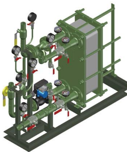
Рисунок 3 Независимая одноступенчатая схема подключения горячего водоснабжения через теплообменный аппарат (Вариант 1.1.)
