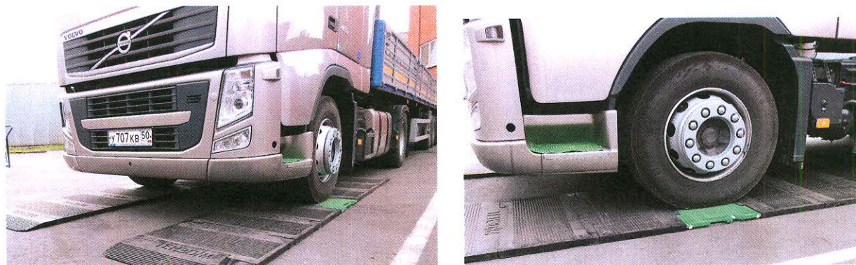
Рисунок 6 – Расположение колеса АТС на грузоприемной платформе при взвешивании.
