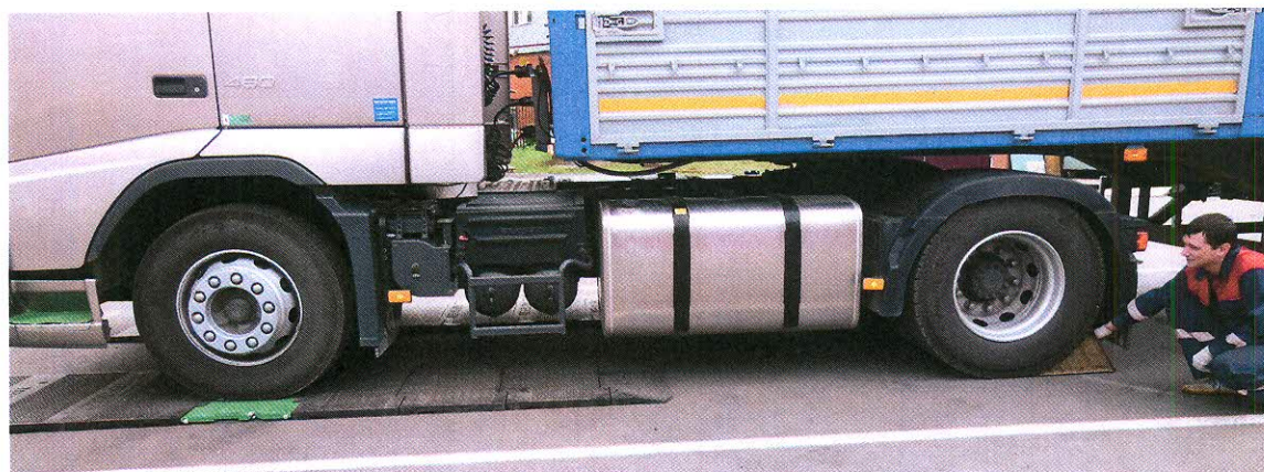
Рисунок 7 – Фиксация колес взвешиваемой оси АТС на грузоприемной платформах при помощи противооткатного "башмака".
