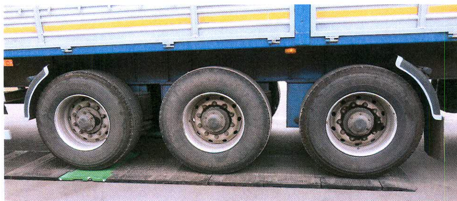
Рисунок 8 – Использование резиновых вставок при определении осевой нагрузки и нагрузки на группу осей для многоосной тележки АТС.
