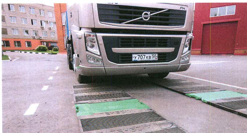
Рисунок 2 – Проверка расположения грузоприемных платформ перед взвешиванием.
