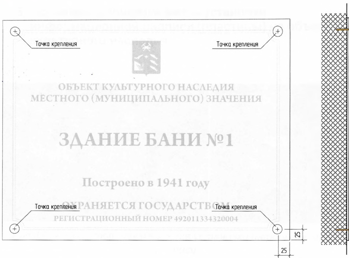
Рис.3 Схема крепления информационной надписи
